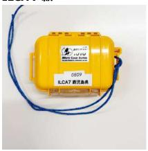
シングルハンド艇は収納する場所がほぼ皆無なので、 デバイス収納箱をグースネックとマスト側バング取付部 の間に結束バンドでしかりと取付けて、ラニヤードでも しっかりと固縛ください。その際、収納箱を密閉してい る面ファスナーベルトは外さないようにしてください。 取付用の結束バンドは機器配布時にお配りします。
