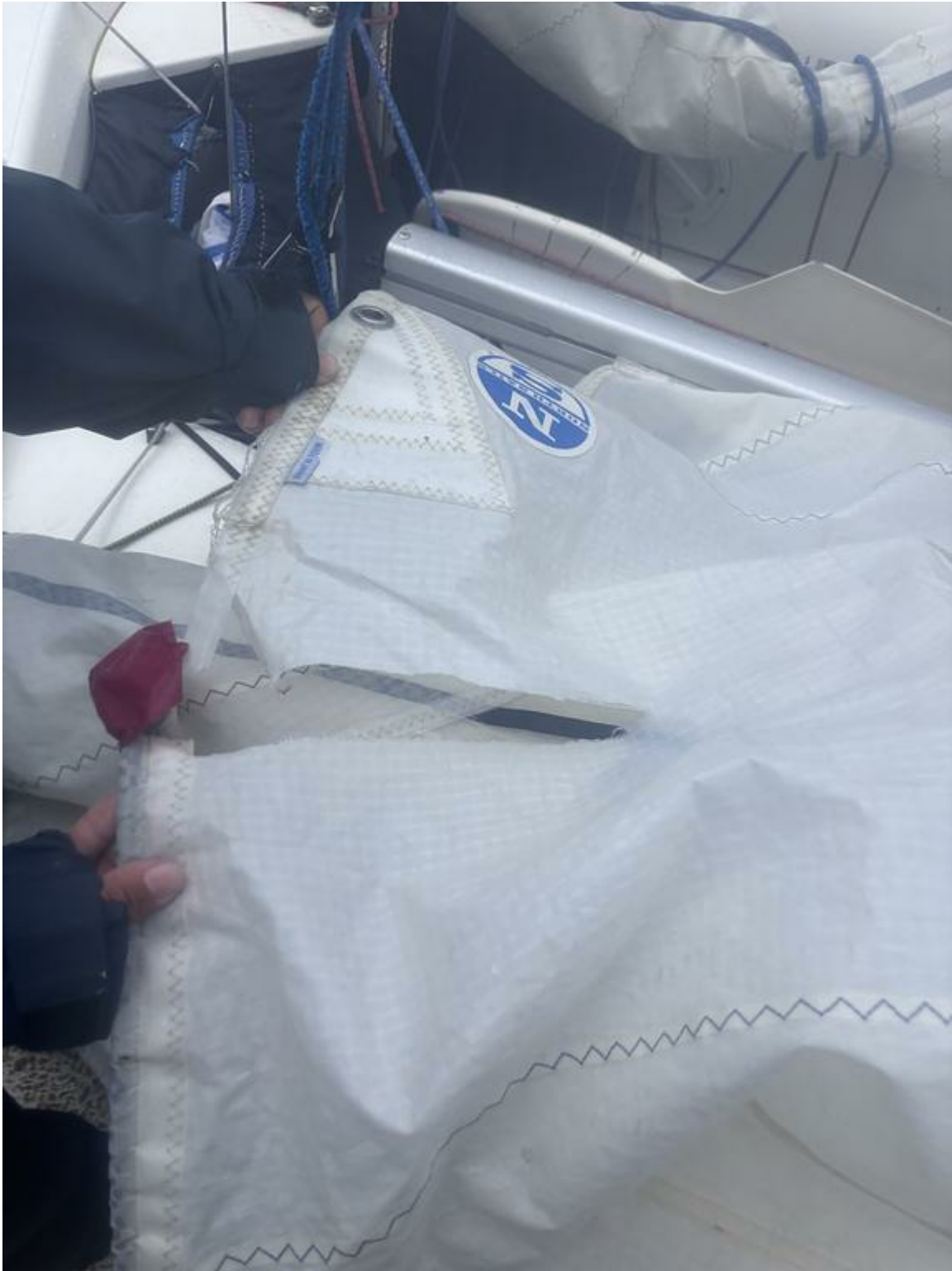
写真のようにラフ側に裂傷が入ってしまいました
