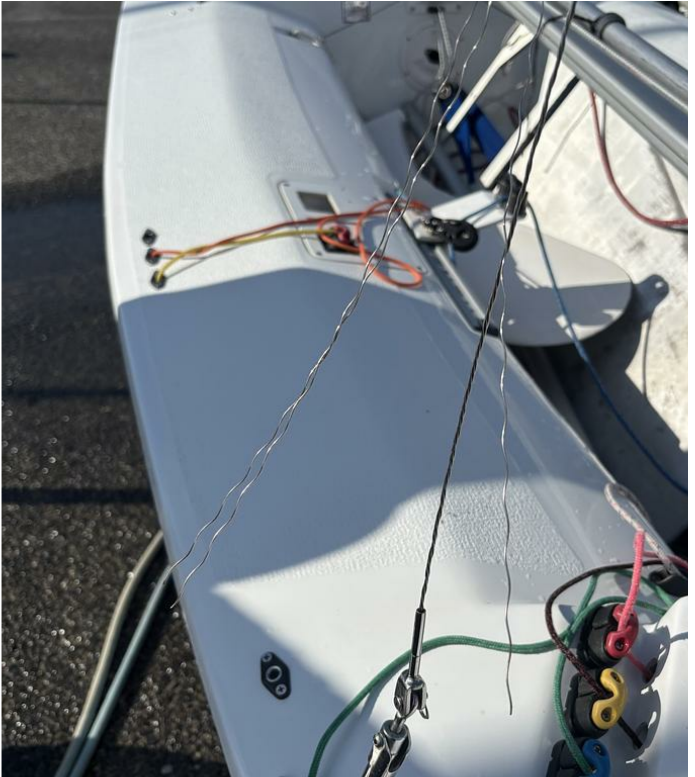
破損したサイドステイ
